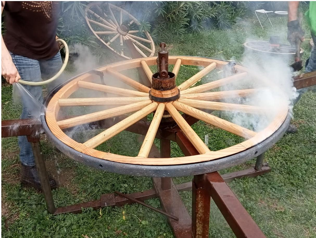
Le charron utilise le bois et le fer pour construire et réparer des véhicules attelés. Le cœur de son métier est sa maîtrise de la roue. Le moyeu est en orme, les raies en acacia et les jantes en frêne. Le cerclage est réalisé par forge et cintrage. La roue est ensuite enchâssée à chaud.
